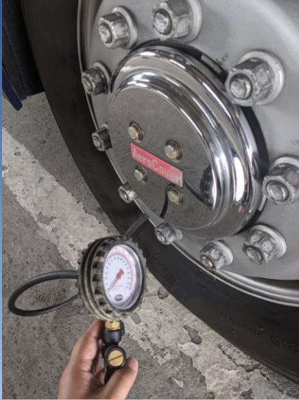
エアーゲージによる 空気圧測定
