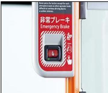
(写真 29,30)乗合バス・ドライバー異常時対応システム〔EDSS〕搭載
