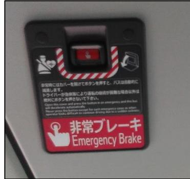
(写真 28)貸切バス・ドライバー異常時対応システム〔EDSS〕
