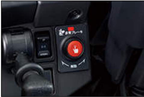
運転士操作用非常ボタン
