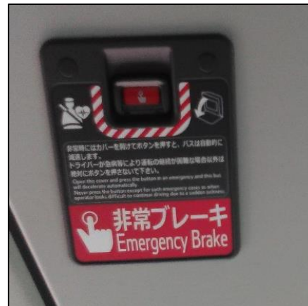
(写真12)エレベーター付き貸切バス・ドライバー異常時対応システム〔EDSS〕搭載
